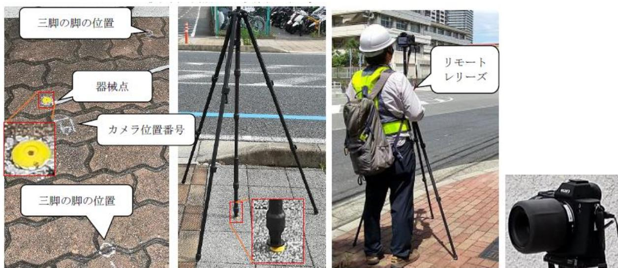
1名の作業員が複数の器械点間を移動しながら計測することを前提に、軽量な専用三脚を用い撮影します。
